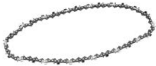
► CORRENTE 1/4", 0,043" (1,1 MM) 56 ELOS PARA BARRA DE GUIA DE 10"
